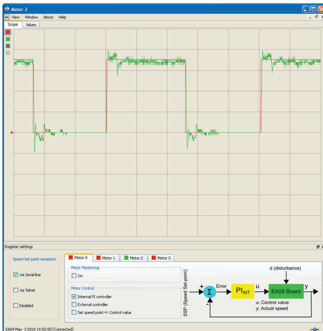
Affichage en ligne des données de consigne de régulation et réelles par un oscilloscope virtuel
